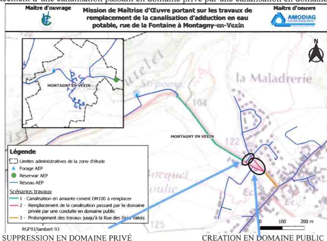
**Scénario n° 3** : travaux de remplacement d'une canalisation en amiante ciment DN 100 mm + remplacement d'une canalisation passant en domaine privé par une canalisation en domaine public + remplacement d'une canalisation en amiante-ciment
