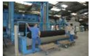
4 Puis, des milliers d'aiguilles fixées sur des planches traversent la nappe sur le dessus et le dessous. La moquette aiguilletée est enroulée. Elle sera utilisée par les équipementiers automobiles pour fabriquer les planches à l'arrière des voitures, les tapis de coffre ou les passages de roues.
