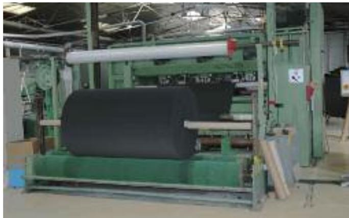
6 L'aiguilleté plat sert aussi à faire des tapis d'habitacle. Dans la machine de "velourage", on traverse à nouveau la nappe avec des milliers d'aiguilles, qui font sortir les poils des fibres. Les poils sont brossés pour former le tapis velours.
